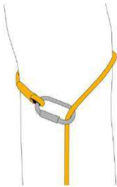
Fig. 2 - Strozzo diretto della fune
