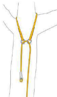
Fig. 8 - Ancoraggio passante per corda raddoppiata
